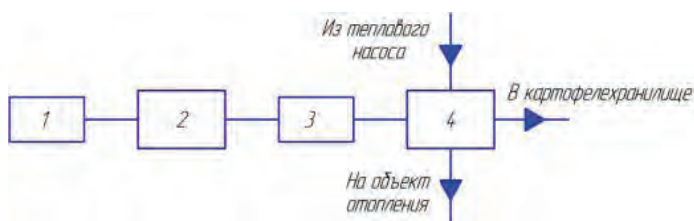
Рисунок 1. Структурная схема релейно - импульсного регулятора теплового насоса:
