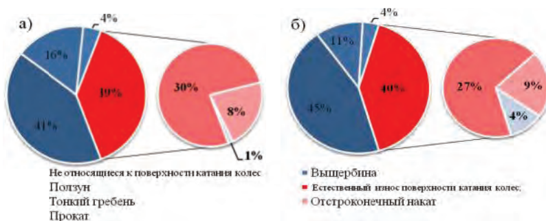
Рис. 3. Причины отцепок грузовых вагонов по эксплуатационным неисправностям: а) на сети дорог ОАО «РЖД» в 2011–2012 гг.; б) холдинговой компании «Новотранс» в 2013–2016 гг.
