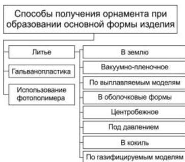
Рис. 2. Классификация способов декорирования получением орнамента одновременно с образованием основной формы
