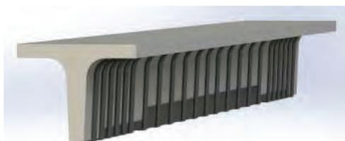
Рис. 5. Наклейка U - образных полос из композитного материала
