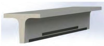
Рис. 3. Наклейка ламелей из композитного материала
