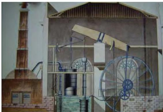
Рис. 3. Паровая машина двойного действия Уатта.
