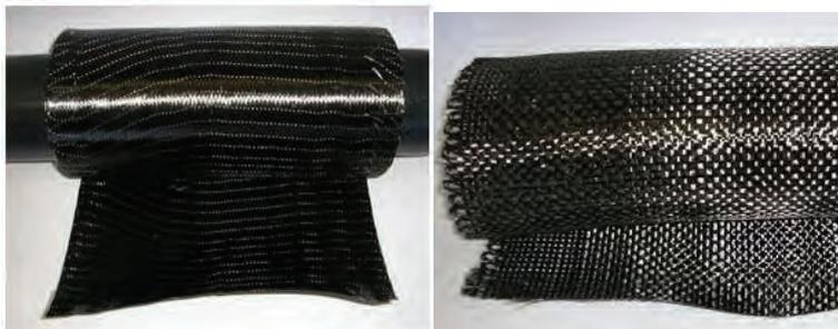
Рис. 1. Полотна углеродных тканей.
