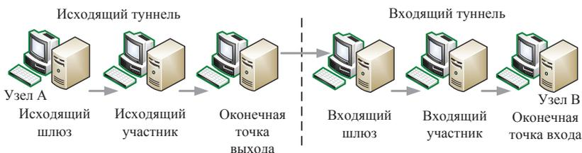
Рисунок 5 - Структурная схема управления трафиком с формированием туннеля
