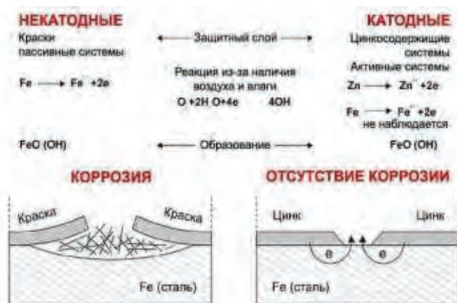
Рисунок 1 - Сравнение методов защиты металлов от коррозии
