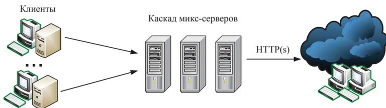
Рисунок 3 – Структурная схема управления трафиком на основе микс - узлов
