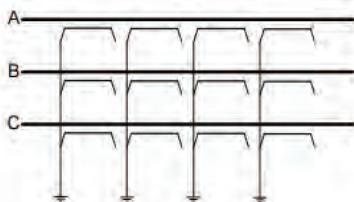
Рисунок 5 Разделение экранов на K = 4 отдельных секций, каждая из которых заземлена только один раз
