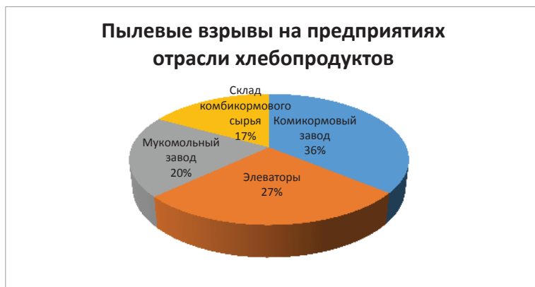
Рисунок 1. Пылевые взрывы на предприятиях отрасли хлебопродуктов
