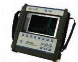
Рисунок 3 – Внешний вид 2 - х канального анализатора вибрации Оникс.
