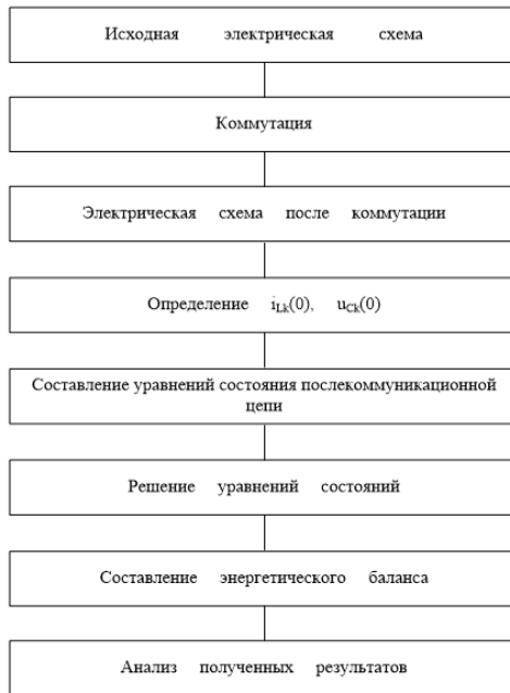
Рисунок 1 – Алгоритм анализа переходных процессов при отсутствии принужденных составляющих токов и напряжений
