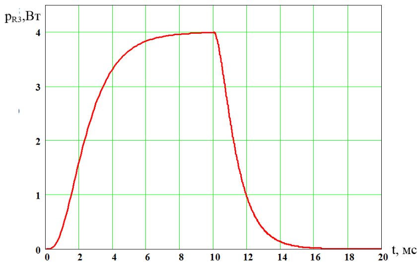
Рисунок 5 – Изменение мощности, выделенной в резисторе R_3 в режиме включения и отключения цепи
