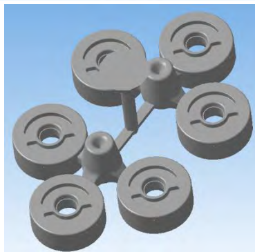
Рисунок 1 – 3D модели кустов отливок с литниково питающими системами
