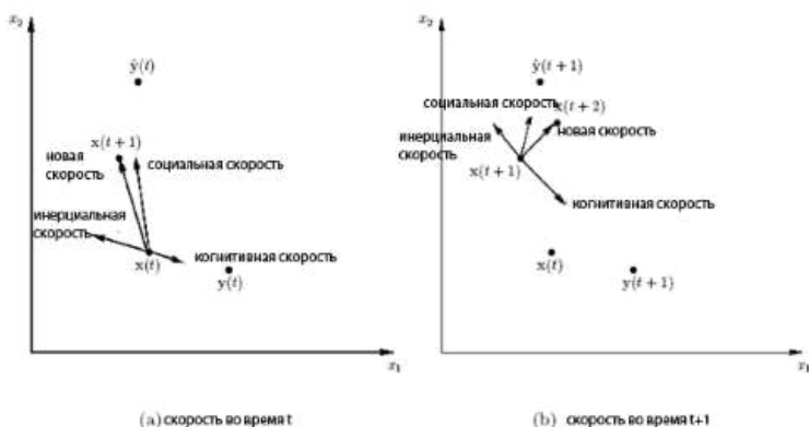
Рисунок 9. Геометрическая иллюстрация изменения позиции и скорости частицы.
