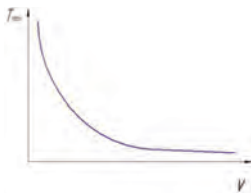
Рис. 2. График истирания графитовых щеток. T_{max} – истирание щеток во времени; V – время.
