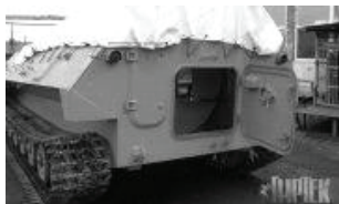
Рис. 1 – Топливозаправщик на шасси гусеничного вездехода ТГМ - 126 (МТЛБ - у)
