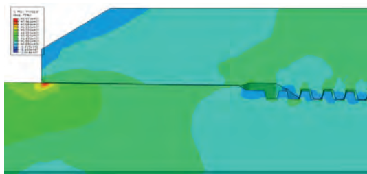
Рисунок 1 - Распределение напряжённости трубного соединения ЛБТ 147х13, полученное расчётом МКЭ, при приложении к трубе знакопеременного изгибающего момента.
