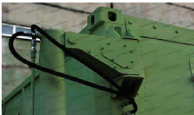
Рис. 2. Крепление гидроопор к кузову – контейнеру
