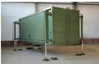
Рис. 4. ГПРУ - 1М на контейнере в рабочем положении
