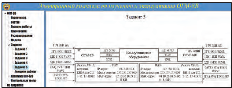
Рис. 7. Организация каналов связи по трактам E1 G.703, WAN и SDSL
