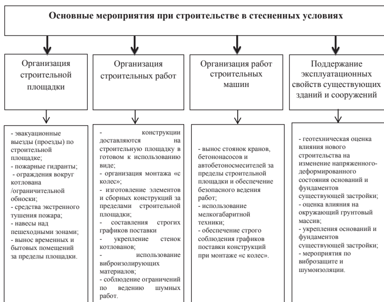
Рисунок 1. Основные мероприятия при строительстве в стесненных условиях
