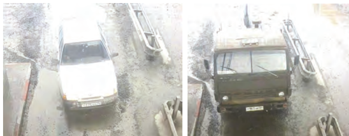
Рис. 5. Результат фиксации номера камерой BD3370 в дневное время
