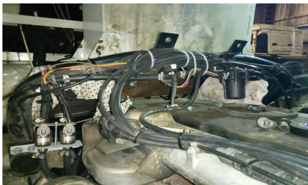
Рисунок 5. Общий вид на расположение газовых форсунок, MAP – сенсор, газовый фильтр, электрическую проводку
