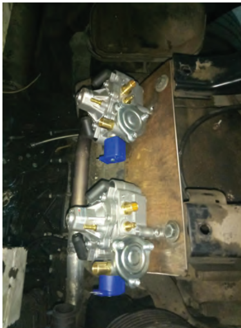
Рисунок 2. Монтаж газовых редукторов
