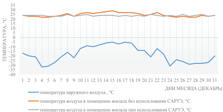
Рис.1. Диаграмма колебания средней температуры наружного воздуха и средней температуры в помещении вокзала Красноярск
