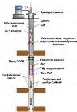
Рис. 2. Схема ОРЭ ШГН - ЭЦН - датчик «Спрут»
