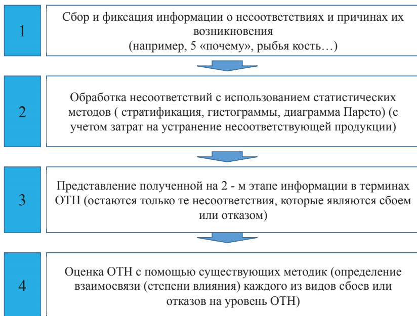
Рис. 3.1.1 Укрупненный состав алгоритма оценки ОТН малоэтажного строительства с учетом значимости выявленных несоответствий и их причин
