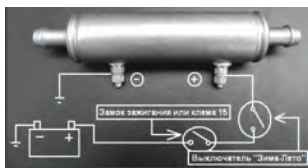
Рисунок 2. Схема включения позисторного подогревателя автомобиля
