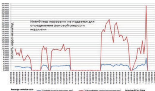
Рис. 1. Замеры скорости коррозии в автоматическом режиме
