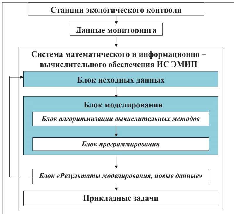
Рисунок 1 – Структурная схема системы моделирования процессов переноса загрязняющих примесей в атмосфере
