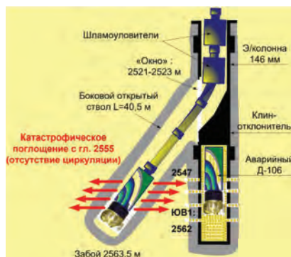
Рис. 1. – Схема работы забойного двигателя со шламоуловителями
