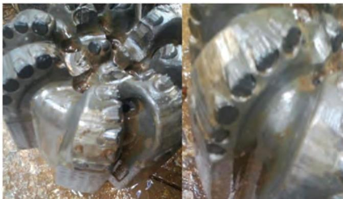
Рисунок 2 – Состояние вооружения традиционного PDC долота
