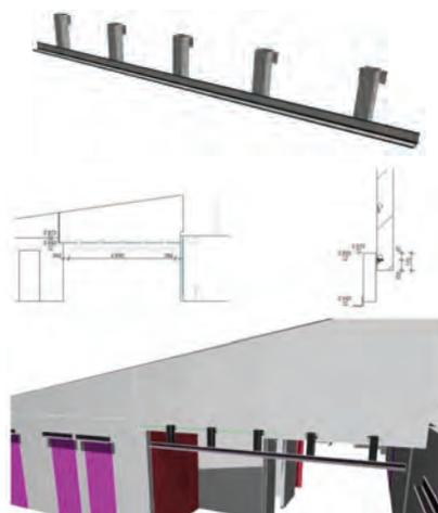
Рис. 3: Несущая конструкция фасада
