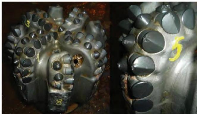
Рисунок 1 – Состояние вооружения долота RDE и CDE
