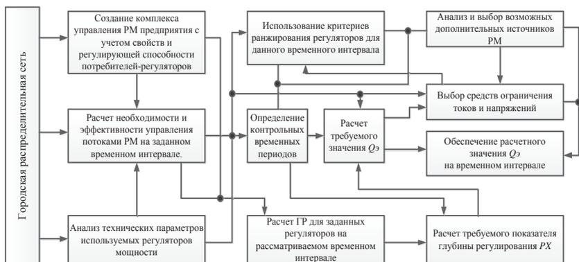
Рисунок 1 –Блок - схема алгоритм управления потоками РМ
