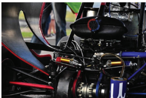
Рис 1 – Ресивер изготовленный из углеволокна с «банкой»
