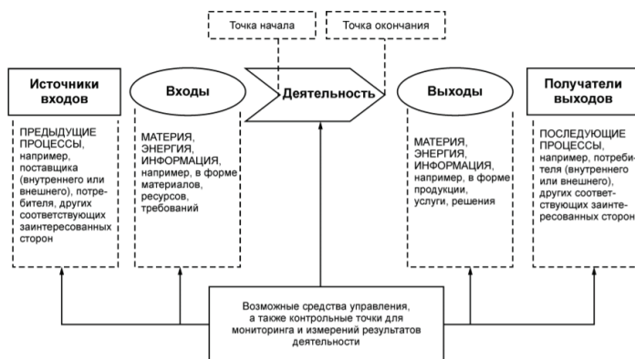
Рис.1 Схематичное изображение элементов процесса цикла «Планируй - Делай - Проверяй – Действуй»
