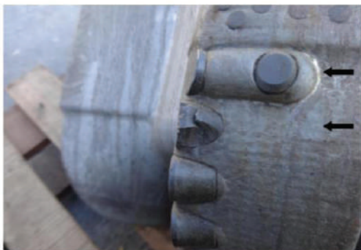
Рисунок 2 – Пример сохранения резца при помощи стабилизирующей вставки
