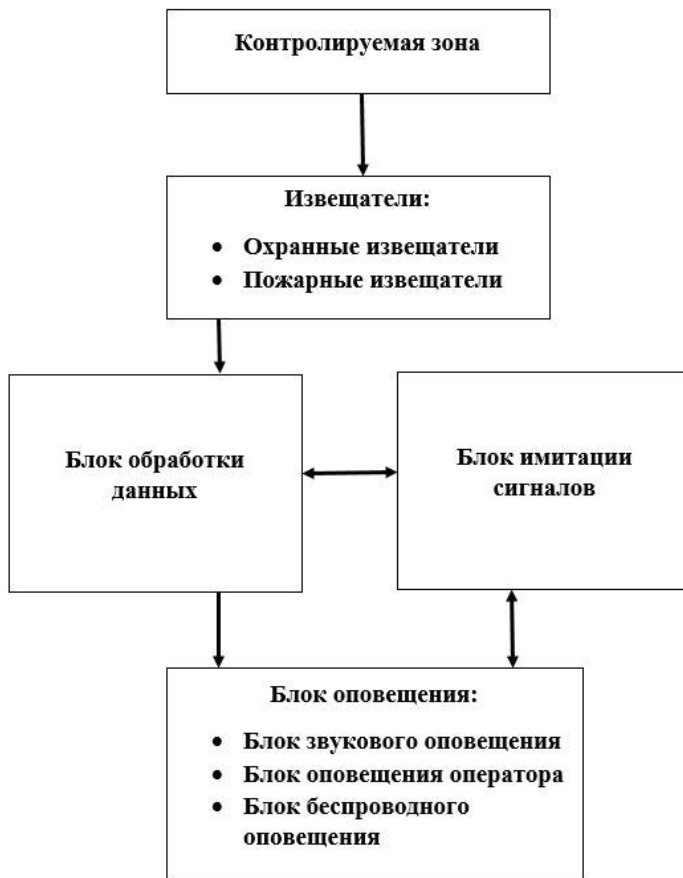
Рисунок 2 - Структурная модель микропроцессорного управления стендом ОПС с беспроводным управлением.
