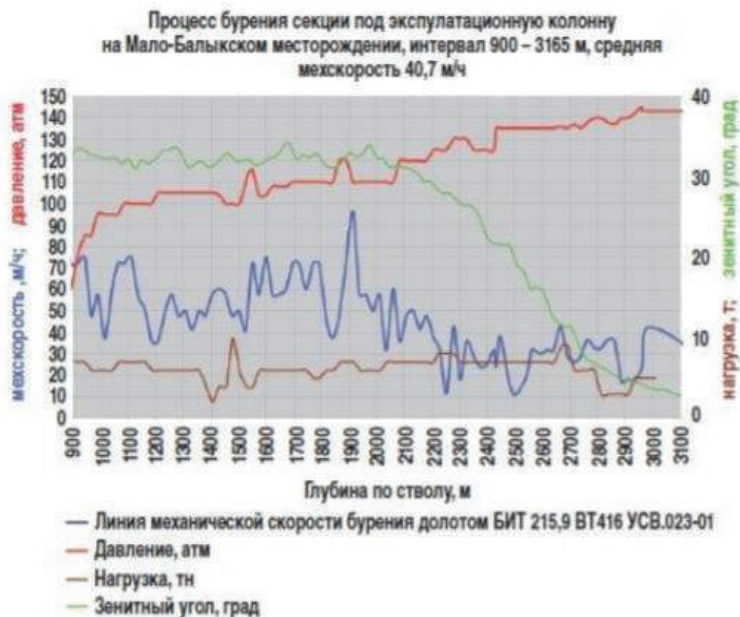
Рисунок 1 – Бурение секции эксплуатационной колонны при помощи БИТ 215,9 ВТ416УСВ
