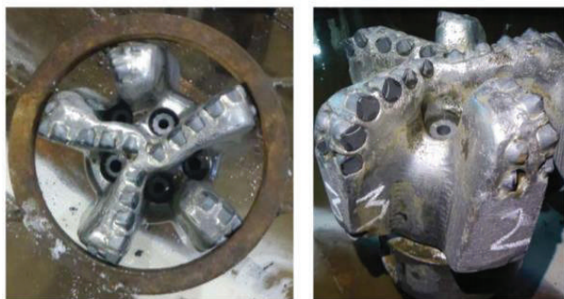
Рисунок 1 – Состояние долота PDC после бурения секции эксплуатационной колонны
