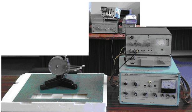
Рис.2.Общий вид стенда для исследования виброизоляторов.
