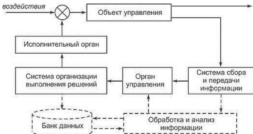
Рисунок - Общая схема управления производственным процессом
