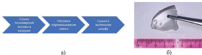
Рисунок 1. Схема получения (а) и внешний вид (б) гелевого - полимерного электролита
