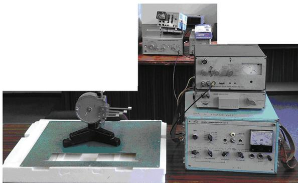
Рис.3.Общий вид стенда для исследования виброизоляторов.
