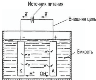
Рис. 1. Электрохимическая очистка стоков
