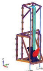
Рисунок 1 - Конечно элементная модель установки насоса на раме с отображением отступов, толщин и поперечных сечений.
