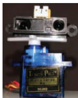
Рис. 1 ИК - датчик расстояния, установленный на качалку сервопривода
