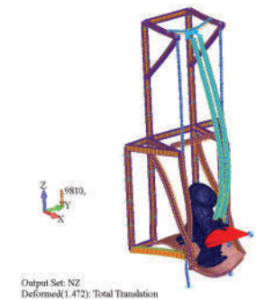
Рисунок 5 – Деформированное состояние конструкции при воздействии единичной перегрузки в направлении оси Z
