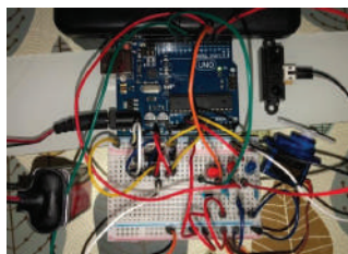
Рис. 2 Схема сканирующего ИК - дальномера
