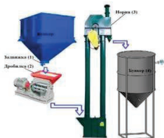
Рисунок 1 – Технологический процесс линии дробления зерна
