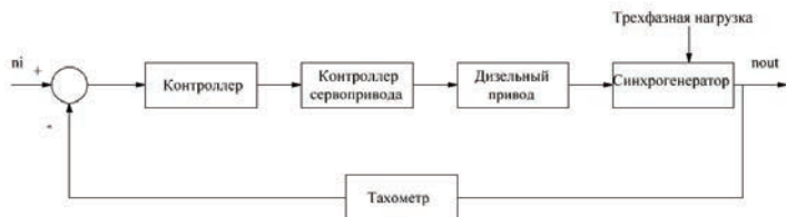
Рис. 2 Система управления с обратной связью по скорости вращения дизельного двигателя
