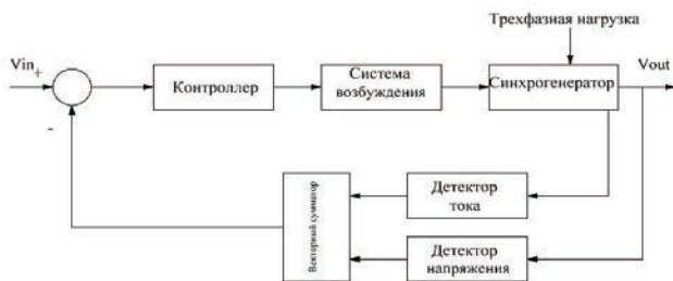
Рис. 3 Система управления возбуждением генератора с обратной связью
