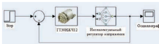
Рис. 2. Виртуальная система с генератором ГТ30НЖЧ12 и интеллектуальным регулятором напряжения
