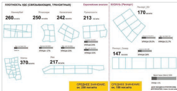
Рис. 2. Сравнительная диаграмма по плотности транзитных сетей УДС и интенсивности застройки фронта улиц.
