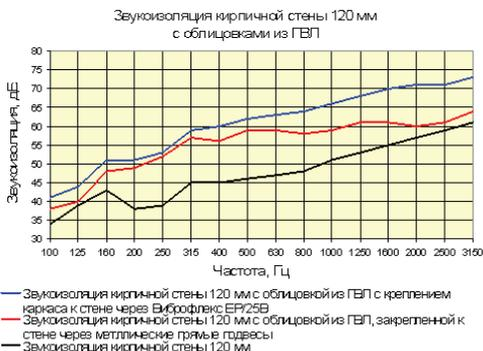
Рис.6. График эффективности звукопоглощения применяемых панелей.
