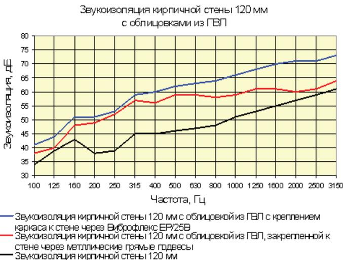
Рис.6. График эффективности звукопоглощения применяемых панелей.
