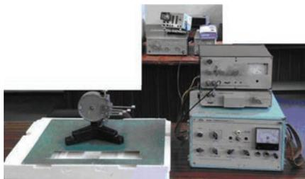
Рис.2.Общий вид стенда для исследования виброизоляторов.
