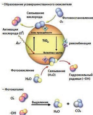
**Рис. 1. Принципиальная схема реакции фотокаталитического окисления**
