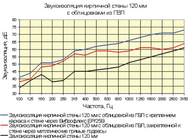
Рис.6. График эффективности звукопоглощения применяемых панелей.
