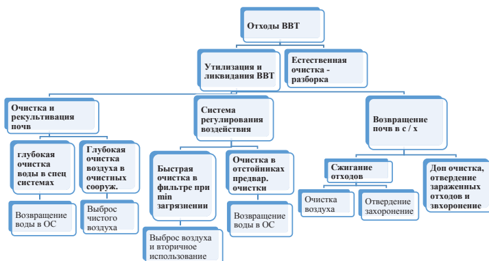
Рис. 2. Система обеспечения безопасности и утилизации ВВТ
