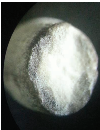
Рис.4. Превращение комплексных солей палладия в металл методом прогрева до 400^{\circ}\text{C} на воздухе (x40).
