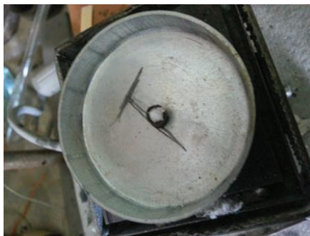
Рис.2. Обработка образца палладиевого катализатора расплавом нитрата аммония
