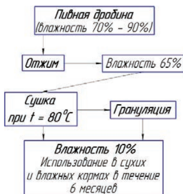
Рис. 2. Технологическая схема получения сухой пивной дробины
