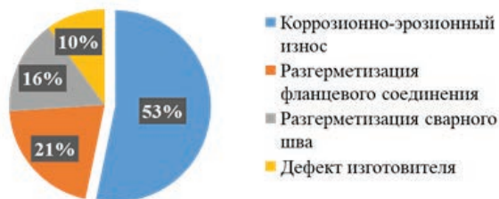
Рис. 1. Технические причины аварийных ситуаций при эксплуатации технологических трубопроводов
