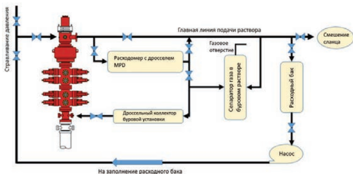
Рисунок 3. Схема циркуляционной системы буровой установки для бурения с регулируемым давлением
