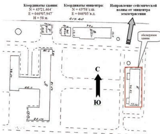
Рисунок 1 – План - схема здания и направление сейсмической волны от эпицентра к зданию
