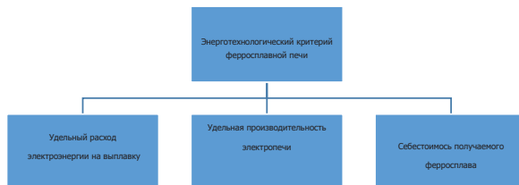
Рисунок 1 – Схема связи величины энерготехнологического критерия печи со следующими параметрами: удельным расходом электроэнергии; удельной производительностью электропечи и цеховой себестоимостью получаемого ферросплава
