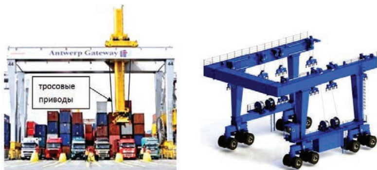
Рис. 1. Контейнерный кран - манипулятор (слева) и кран для яхт (справа).
