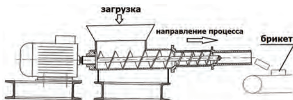
Рис. 1. Устройство экспериментального брикетера.
