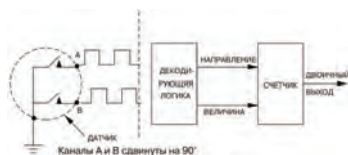
Рисунок 2. Схема датчика EAW0J - B24 - AE0128L
