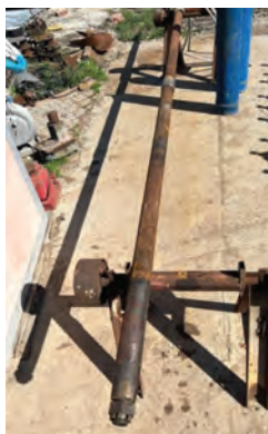
Рисунок 1 – Фото поврежденного гребного вала
