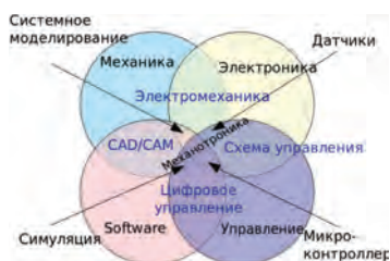
Рисунок 4. Схематическое представление понятия "мехатроника"
