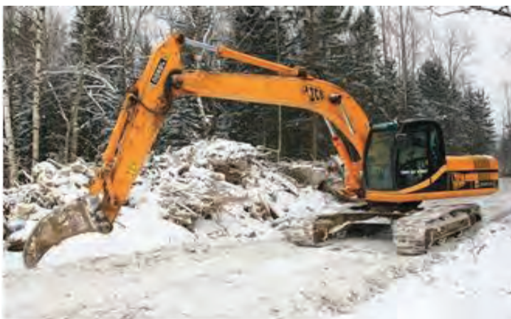
Рисунок 1 - Гидравлический экскаватор с рабочим органом – зубом – рыхлителем
