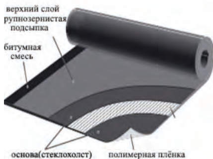
Рис. 4. Состав стеклоизола
