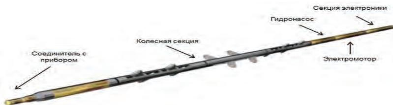
Рисунок 3 – Общий вид скважинного трактора [4]
