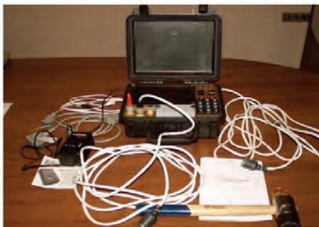
Рисунок 2. Состав комплекса, измеряющего длину свай «ИДС - 1»
