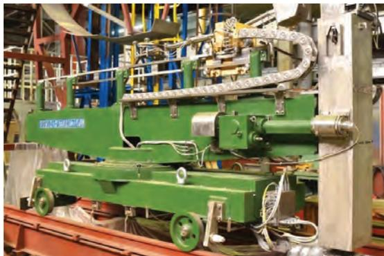
Рисунок 1. Система наружного контроля корпуса реактора СК.187
