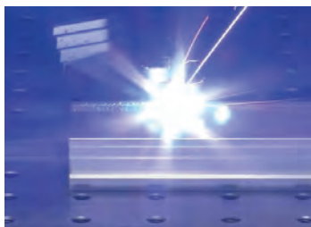
Рис. 2. Импульсный оптический разряд над металлической поверхностью при интенсивностях лазерного излучения J > 10^7 Вт / см 2
