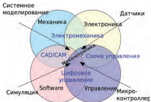
Рисунок 1. Схематическое представление понятия "мехатроника"
