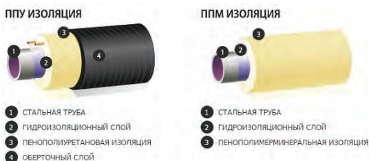
Рис. 1. Структура ППУ и ППМ изоляции
