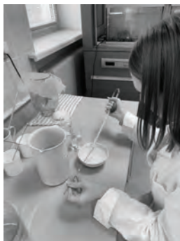
Рисунок 2. Проведение биотестирования с использованием дафний
