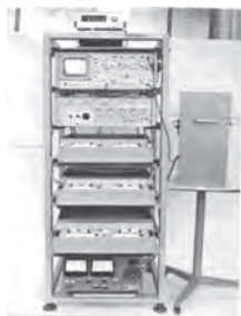
Рисунок 2. Установка релаксационной спектроскопии глубоких уровней, работающая с ПЭВМ ДВК - 3. [5,12,13,23,24,29]
