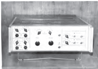
Рисунок 1. Анализатор долговременных релаксационных процессов в поверхностно - барьерных структурах [34]
