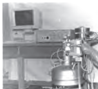
Рисунок 3. Установка нестационарной спектроскопии глубоких уровней на базе IBM PS [7 - 9,12,15,17,23 - 29]
