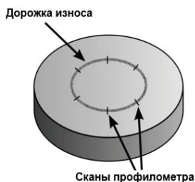
Рис. 3 – Схематическое изображение дорожки износа и измерения с помощью поверхностного профилометра (сканы)
