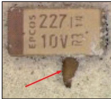
Рисунок 10 – Повреждение корпуса конденсатора во время пайки
