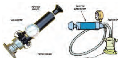
Рисунок: Проверка крышки радиатора.
