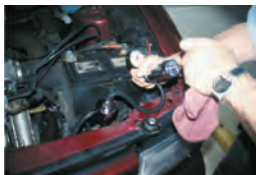
Рисунок: Опрессовка системы охлаждения.
