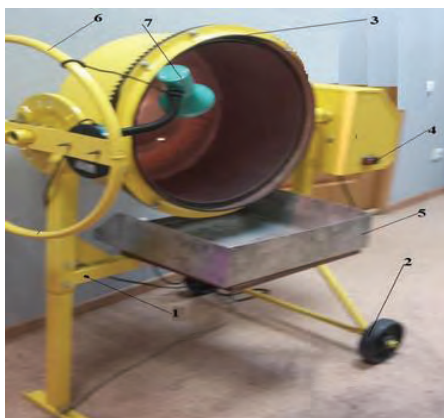
Рис. 1 – Окомкование шихты в лабораторном окомкователе
